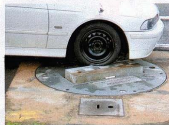
При наезде на бордюр шина сминается до самого обода. Обод усиленный — если проводить испытания на стандартных колесах, их пришлось бы менять после теста каждой шины
