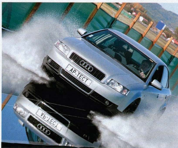
Испытания на сопротивление шин аквапланированию мы проводили на Audi A4, оборудованном специальной аппаратурой. Автомобиль, попав в ванну с восьмимиллиметровым слоем воды, разогнался с максимальной интенсивностью до полной потери контакта ведущих колес с дорогой. Скорость автомобиля, при которой аппаратура фиксирует 10-процентную пробуксовку колес, идет в итоговый протокол
